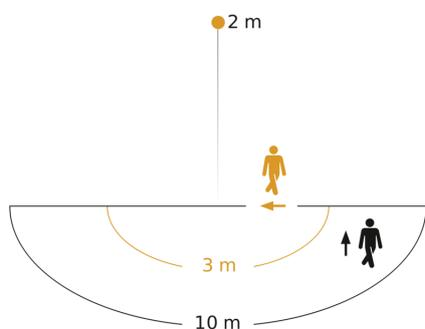
Possibile altezza di montaggio: 1,80 m – 3,00 m
